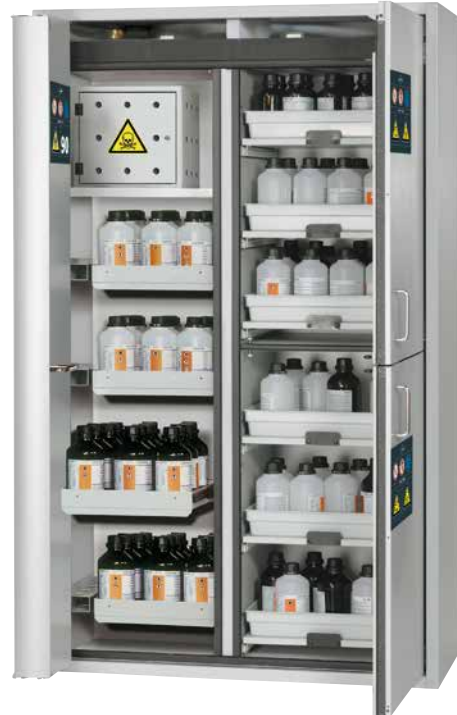
Combinatie-brandveiligheidsopslagkast model K90.196.120.PHOENIX Vol. 2 , in de kleur lichtgrijs (RAL 7035), vouwdeur met TSA-deurvastzetinrichting (automatisch deursluitsysteem), interieur linker compartiment: 4 schuifladen in staal met epoxycoating en apart afsluitbaar gifkluisje, interieur rechter compartiment: 6 schuifplateaus met uitneembare kunststof opvangbakken, Bestelnr. 11-1918 EU bestelnr. 30336-001-30756
