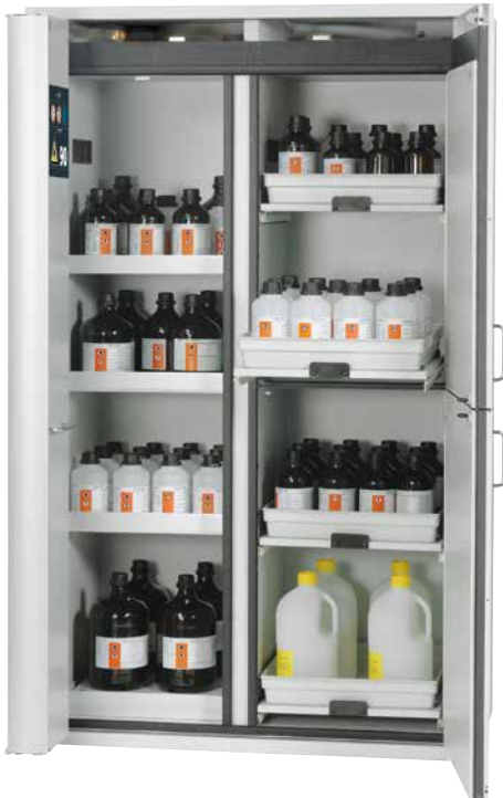
Combinatie-brandveiligheidsopslagkast model K90.196.120.PHOENIX Vol. 2 , in de kleur lichtgrijs (RAL 7035), vouwdeur met TSA-deurvastzetinrichting (automatisch deursluitsysteem), interieur linker compartiment: 3 opvanglegborden (12 liter) en bodemopvangbak (22 liter) in staal met epoxycoating, interieur rechter compartiment: 4 schuifplateaus met uitneembare kunststof opvangbakken, Bestelnr. 11-1148 EU bestelnr. 30334-001-30834+30614
