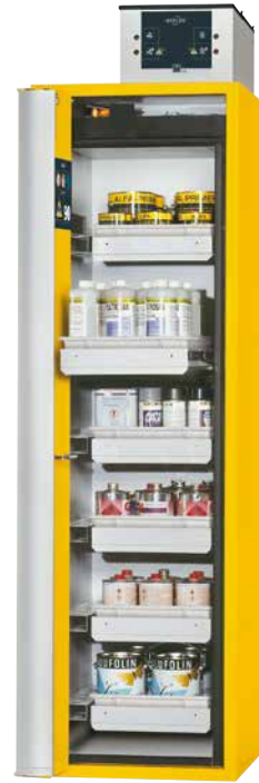
Brandveiligheidsopslagkast S90.196.060.PHOENIX VOL.2, in de kleur signaalgeel (RAL 1004) met TSA-deurvastzetinrichting , interieur met 6 schuifladen (staal met epoxycoating), recirculatie-opzetunit optioneel, Bestelnr. 11-1076 EU bestelnr. 30235-002-30269
