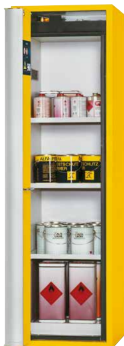
Brandveiligheidsopslagkast S90.196.060.PHOENIX Vol. 2 in de kleur signaalgeel (RAL 1004), met TSA-deurvastzetinrichting , interieur met 3 opvanglegborden (12 liter) en bodemopvangbak (22 liter) in staal met epoxycoating, (NB: afbeelding wijkt af van deze specificatie) Bestelnr. 11-1078 EU bestelnr. 30235-002-30834
