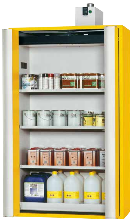
Brandveiligheidsopslagkast S90.196.120.PHOENIX Vol. 2 in de kleur signaalgeel (RAL 1004), met AGT en TSA-deurvastzetinrichting , interieur met 3 opvanglegborden (33 liter) en bodemopvangbak (55 liter) in staal met epoxycoating, ventilatie-opzetunit optioneel, (NB: afbeelding wijkt af van deze specificatie) Bestelnr. 11-1070 EU bestelnr. 30119-002-30830
