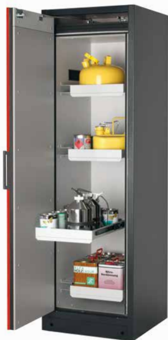
Brandveiligheidsopslagkast model Q90.195.060.PEGASUS met deur in de kleur verkeersrood (RAL 3020) en scharnieren links, interieur met 4 schuifladen (staal met epoxycoating), afdekplint optioneel Bestelnr. 11-1803
